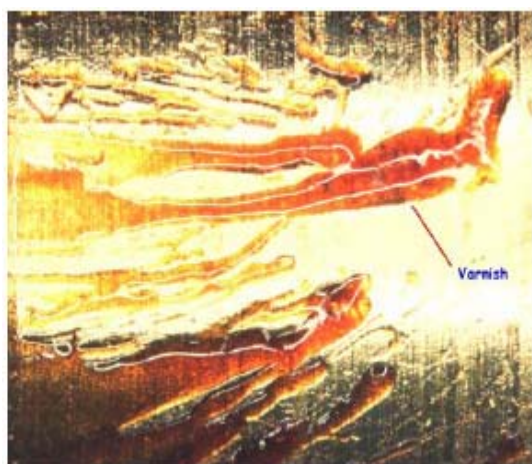
图 2： 伺服过滤器上的油泥
